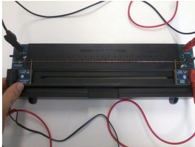
Figura 08: Tirando as pontas de prova da posição "Estacionado".
