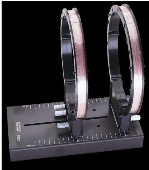
Figura 04: Bobinas a uma distância entre si de 10,00 cm.
